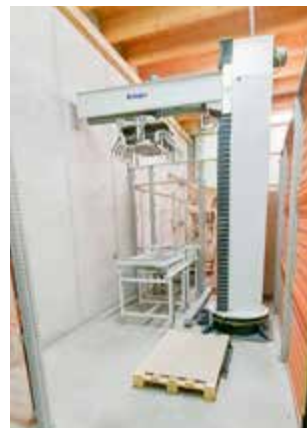
Paletten-Packstation: Hier werden die 25-kg-Säcke auf Palette gestapelt.
