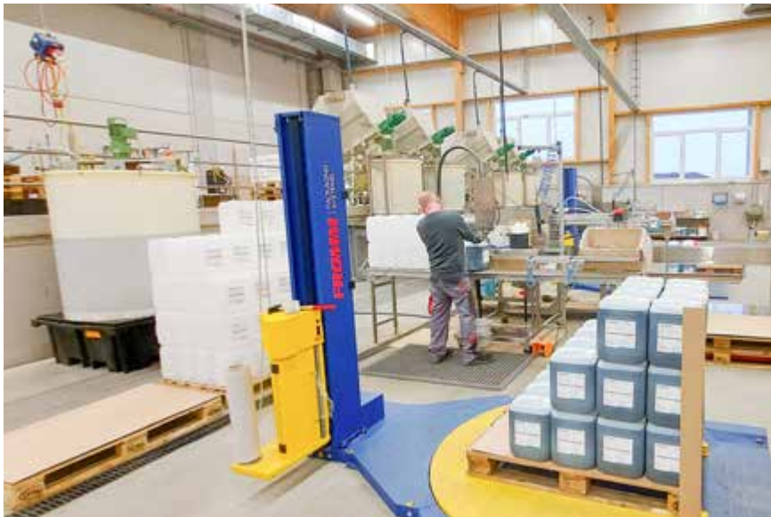
Eine von mehreren Kanisterabfüllstationen. Der Mitarbeiter im Vordergrund füllt gerade das Produkt AKRA AZO+ in 10-Liter-Kanister ab und stellt sie auf eine Palette.
